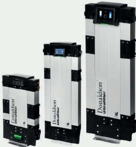
Contamos con secadores del tipo refrigerativo, regenerativo (con y sin pérdida de calor) y de membrana, los cuales garantizan aire seco con punto de rocío de 3 °C para los refrigerativos, y hasta -70 °C para los regenerativos. Nuestros secadores garantizan un ahorro de hasta 25% de energía contra los secadores tradicionales. Contamos con equipos capaces de generar aire respirable para unidades autónomas en casetas de pintura, granallado o revisión de tanques.
